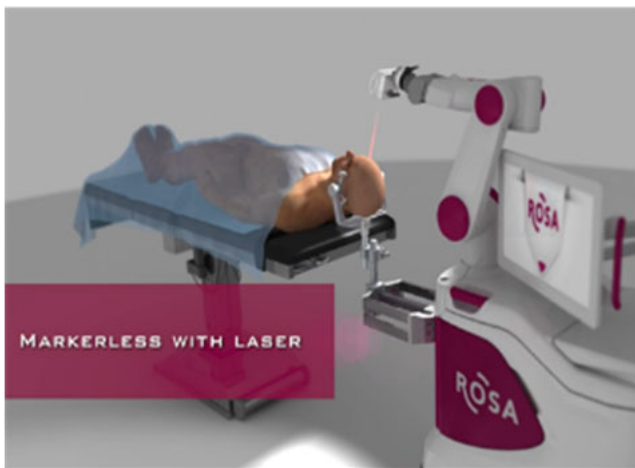
그림 110. ROSA의 레이저를 활용한 수술부위 매칭 과정
