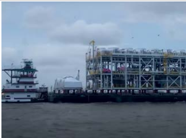
그림 202. 배를 통해 운송되는 Plaquemines LNG 모듈
