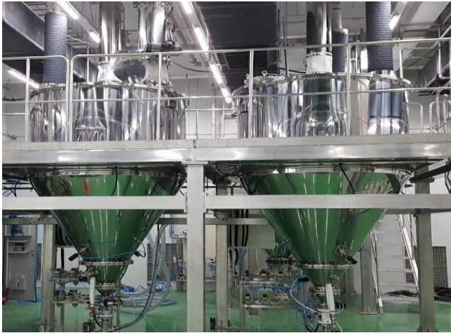
그림 28. PHS: 진공을 이용하여 분체를 이송하고 계량하는 시스템
