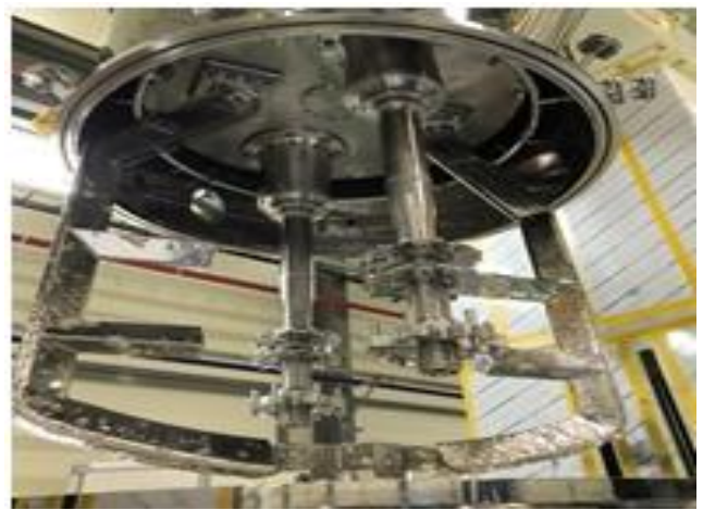
그림 29. Pre-Mixer: 바인더와 도전재를 전 단계에 혼합하는 장비
