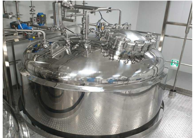
그림 33. 저장 Tank: 최종 슬러리를 보관하기 위한 제반 탱크
